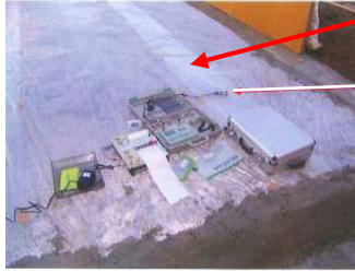
改良杭上の測定
